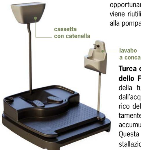
**Turca e risciacquo con acqua pulita di acquedotto (modello FIRENZE pag.11 e BERLINO pag.15)** Il risciacquo della turca avviene tramite l'apposita cassetta alimentata dall'acquedotto oppure da serbatoio di stoccaggio. Lo scarico dell'acqua reflua mediante un sifone è convogliato direttamente alla pubblica fognatura, ad un serbatoio interrato di accumulo o ad una vasca biologica prima di essere smaltito. Questa tipologia di bagno è studiata appositamente per le installazioni fisse.
