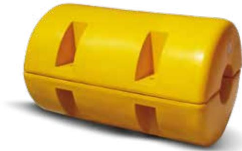
I galleggianti per dragaggi sono formati da due semigusci in PE che vengono posti intorno al tubo e fissati tra loro con dei bulloni in acciaio INOX. Questi hanno una struttura nervata esternamente e, su richiesta, un riempimento in espanso, per garantire la massima rigidità e indeformabilità.
