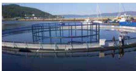
Gabbie galleggianti per il posizionamento delle reti anti-uccelli per la protezione degli allevamenti, formate da tubo HDPE di diametro variabile per formare un telaio secondo schema e dimensioni suggerite dal cliente in base alle esigenze.
